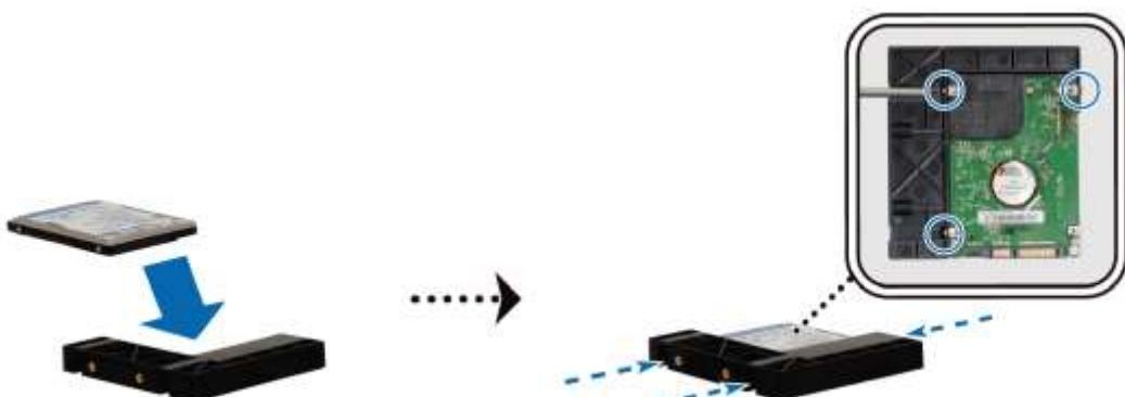
b 2,5" Disk Tutucuyu sabit sürücü yuvasına sürüün ve sürücü SATA konnektörüne sıkıca bağlanana kadar tamamen itin. Disk Tutucuyu verilen vidalarla tespit edin.
