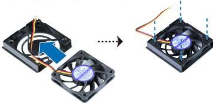
6 Fan elektrik kablosunu aşağıda gösterildiği gibi DiskStation içine takın.
