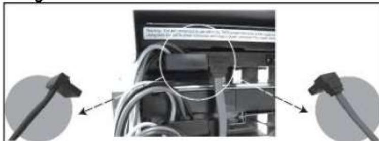
10. Kablo bağlarını kullanarak HDD güç kabloları ile HDD data kablolarını düzenleyin.
