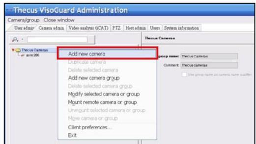
Geben Sie bei jeder neu hinzugefügten Kamera die richtigen Kameraeinstellungen ein und bestätigen Sie diese mit der Save (Speichern)-Schaltfläche. Die Kamera erscheint in der Camera (Kamera)-Gruppe.
