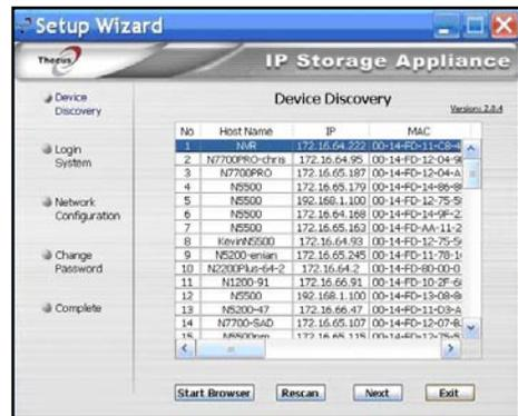
Para cambiar la dirección IP, simplemente haga clic en el sistema deseado en la lista de direcciones descubiertas, y siga las indicaciones del asistente paso a paso para completar las configuraciones.
