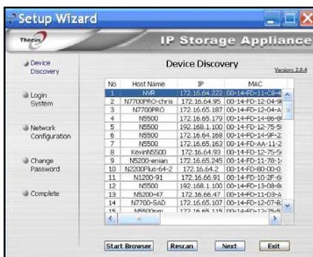
Per modificare l'indirizzo IP, basta fare clic sul sistema desiderato dall'elenco delle scoperte e seguire la procedura guidata passo dopo passo per completare l'installazione.
