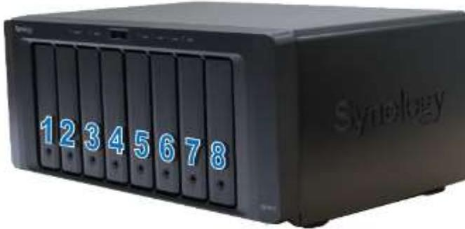
**Not:** Bir RAID birimi oluşturmak isterseniz, sürücü kapasitesinden en iyi şekilde yararlanmak için takılan tüm sürücülerin aynı büyüklükte olması önerilir.
