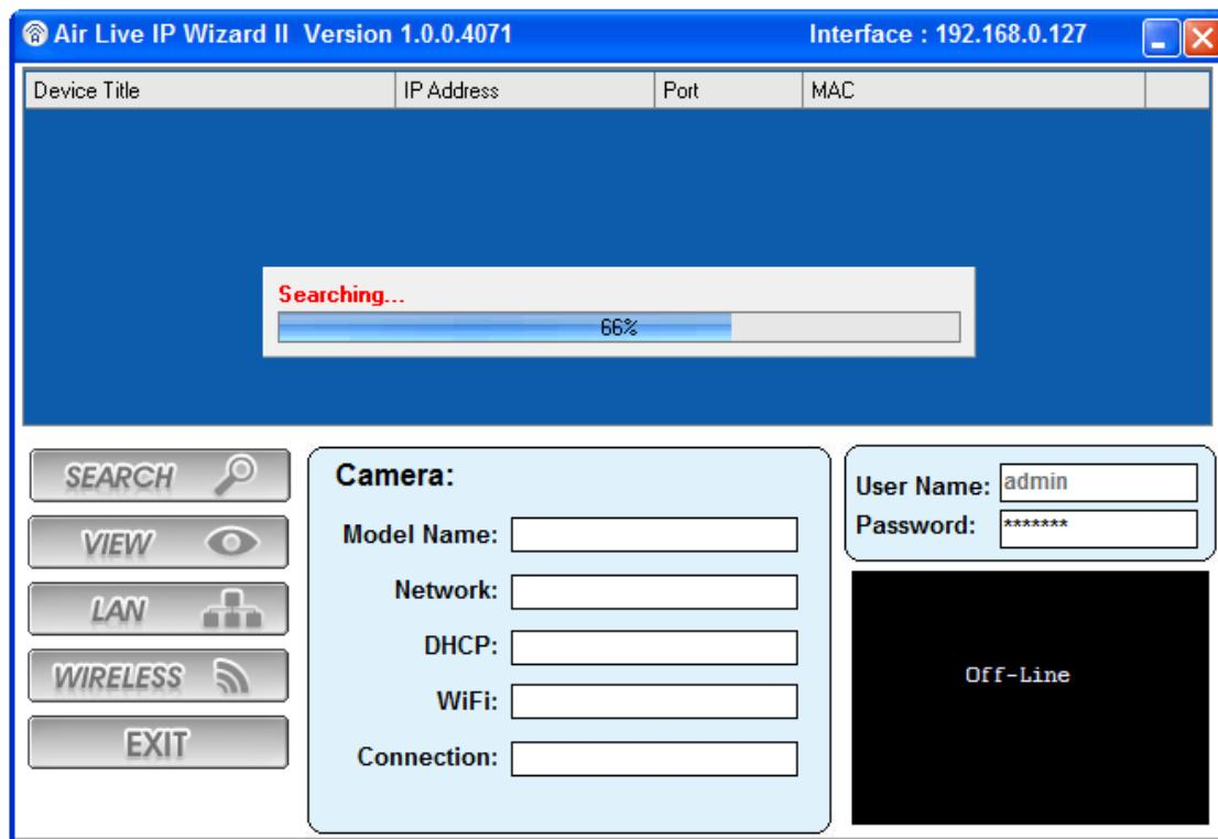
Kameranın IP adresi LAN ile aynı IP segmentinde ise, IP Kameranızın üzerine çift tıklayın. Ardından, varsayılan tarayıcı görünecektir ve otomatik olarak IP kameranın Web'e ara yüzü açılacaktır.
