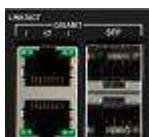
**Combo Port** ; İki (2) fiziksel bağlantıya sahip tekli mantıksal bir bağlantı noktasıdır, RJ45 konektörü (bakır) ve SFP konektörü (fiber)
