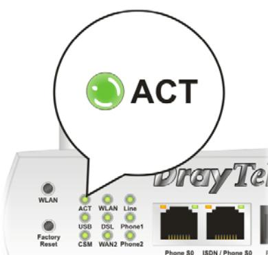
Cihaz ile fiziki bağlantınızın çalışıp çalışmadığını kontrol etmek için bilgisayarınızdan cihazı ping ediniz.
